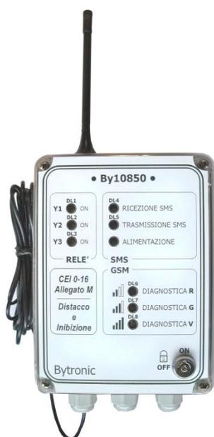
Sistema di distacco e inibizione da remoto (rete GSM) di un gruppo di generazione.
