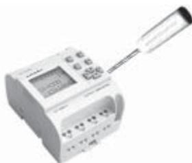
Fig.2.2 – Rimuovere il pannello LCD come da istruzioni
